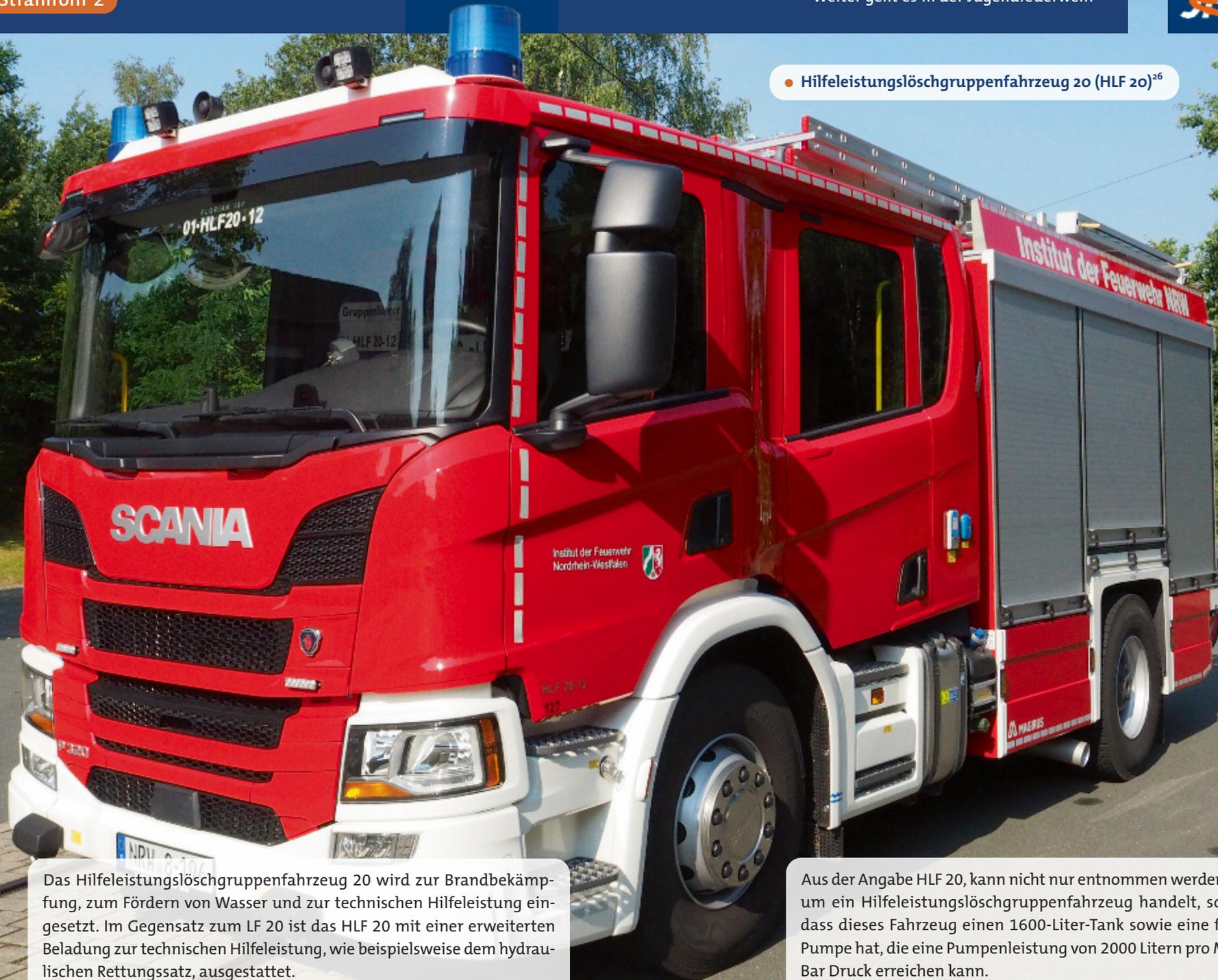
Das Hilfeleistungslöschgruppenfahrzeug 20 wird zur Brandbekämpfung, zum Fördern von Wasser und zur technischen Hilfeleistung eingesetzt. Im Gegensatz zum LF 20 ist das HLF 20 mit einer erweiterten Beladung zur technischen Hilfeleistung, wie beispielsweise dem hydraulischen Rettungssatz, ausgestattet.
