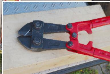
**Schritt 2:** Die Griffstangen werden zusammengedrückt bis der Nagel durchtrennt ist.
