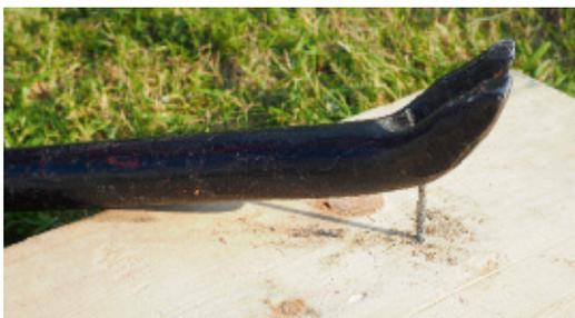
**Schritt 2:** Durch das Herunterdrücken der Metallstange wird der Nagel herausgezogen.
