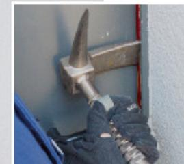
**Schritt 2:** Durch Herunterdrücken der Metallstange wird der Spalt zwischen Rahmen und Türblatt mechanisch vergrößert.
