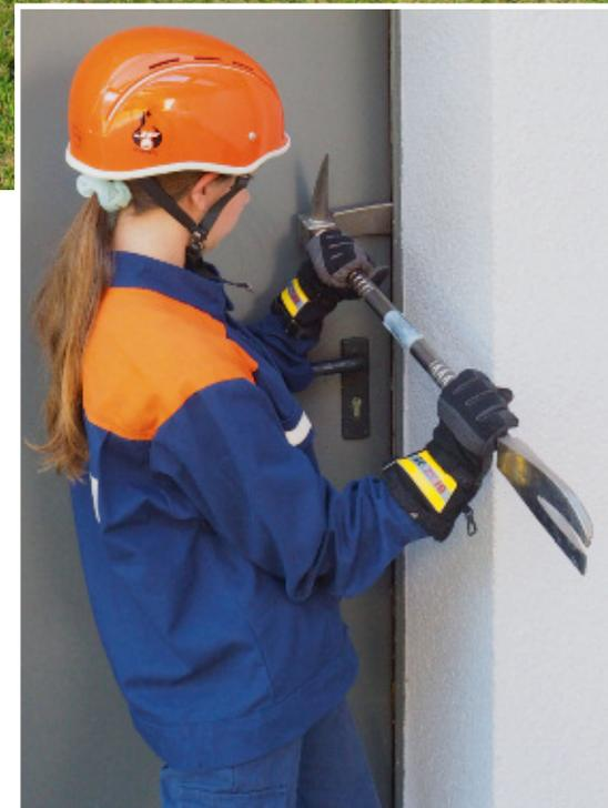
Die Feuerwehr hat hierfür unterschiedliche Geräte zur einfachen Technischen Hilfeleistung, wie zum Beispiel den Hebebaum oder das Halligan-Tool.
