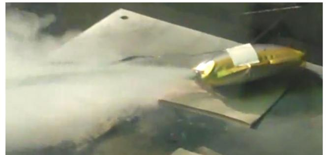
Abbildung 1: Zersetzung von kleinem Li-Ion Akku. Ausdehnung der Zelle und Abblasen („Venting“). Stichflammenbildung steht kurz bevor.
