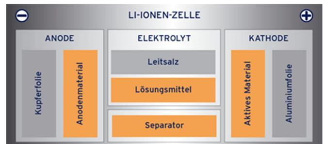
Abbildung 2: Prinzipieller Aufbau von Li-Ionen Zellen mit den vier grundsätzlichen Komponenten: Anode, Kathode, Elektrolyt und Separator; die rot hinterlegten Komponenten können einen Brand beeinflussen.
