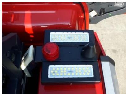
*Erkundungsscheinwerfer in Kombination mit Blitzleuchte der Spannungswarneinrichtung an einem Hubrettungsfahrzeug der Feuerwehr Oberhausen.*
